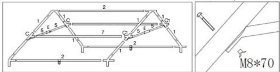
Mettez en place les barres de renfort au toit. Reliez les tubes n°5 entre eux avec les jonctions E pour les côtés pignons et pour les travées intermédiaires, puis fixez les aux jonctions C et C1 à l'aide de vis M8\*70.
