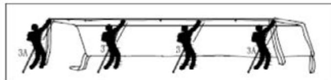
Inclinez l'un des côtés de la structure pour monter les pieds (tubes n°3) dans les jonctions A et B. Procédez de la même manière de l'autre côté afin de redresser la tente, et qu'elle soit entièrement montée.
